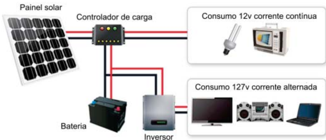
DIAGRAMA DAS LIGAÇÕES DO SISTEMA FOTOVOLTAICO ISOLADO
